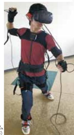
HMDと動作計測装置を装着した学習者 インテリジェントシステム(ロボティクス・メカトロニクス講座)
