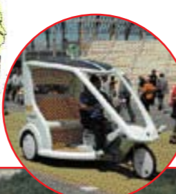
◀自転車タクシー 排気ガスを出さない、 人と電気で動く無公害 三輪タクシー
