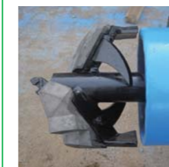
苦心の末に開発された掘削・締め固め両用のブレード
