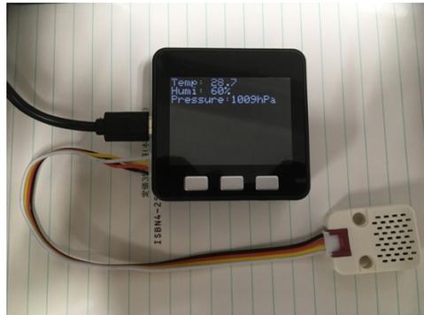
図 環境測定センサを接続した M5Stack
