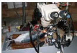
図1 さかなの味覚器が反応する物質を神経から活動電位を導出して調べます。
