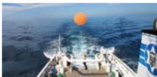
図1 練習船勢水丸からバルーンを上空に飛ばして、上空の気流や気温湿度を観測しています。
