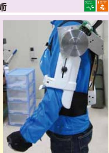
制御システム研究室では、医師に代わり医療診断するロボット、人の筋力を補うパワーアシストスーツ、危険地帯で人に代わり作業する遠隔操作ロボット、などの次世代ロボットを研究開発しています。機械装置、電子回路、ソフトウェアまで一貫して研究開発することで、独創的な制御システムを生み出し、その成果を国際会議などで世界に発信しています。
