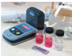
▲試薬で塩素を着色し濃度を計測しています
