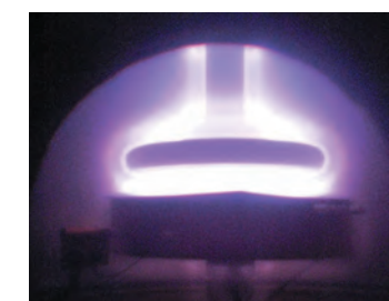
▲ プラズマ中でのカーボンナノチューブの生成の様子
