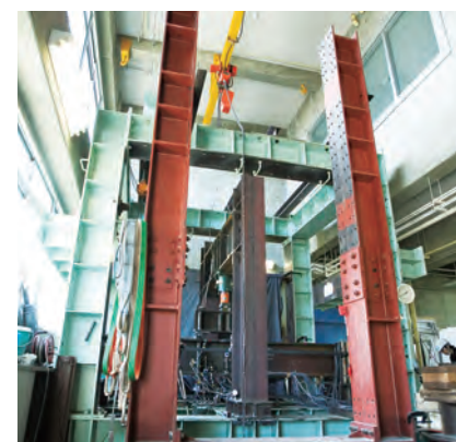
▲ 1MN級大型構造物試験装置
