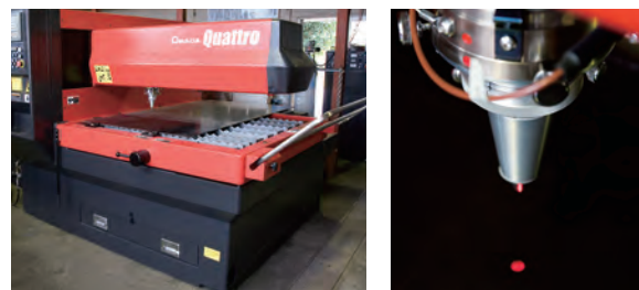
▲ レーザによる銅板の精密切断
