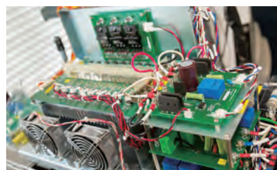
▲ マトリックスコンバータ実験装置
