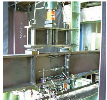
▲ 鋼構造接合部の性能実験
