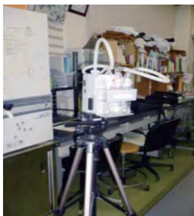
作業環境測定サンプリング状況（液体捕集法）
