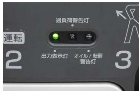
※エンジンが始動したら、ミドリのランプが点灯し続けることを確認して下さい。
