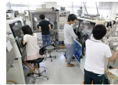
水に不安定な材料を取り扱うために、低湿度雰囲気を作り出すグローブボックス中で実験作業を行う。
