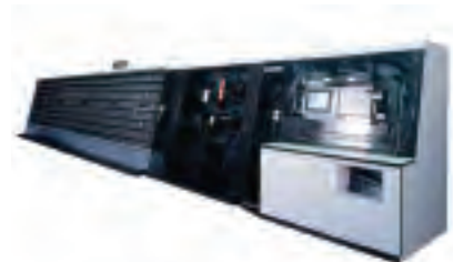
文字・パターン認識技術を用いた郵便区分機(図1)
