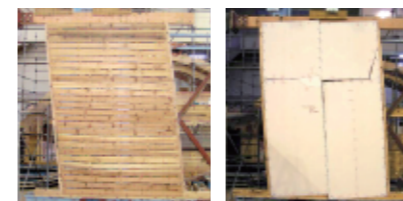
壁実験の様子 左:木ずり 右:石こうボード(図4)
