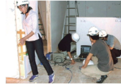
微動実験(人力加振)の様子(図1)
