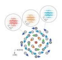
磁気ボルテックスのスピン渦構造(図2)
