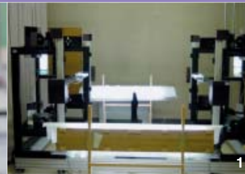
1. 非接触3次元カラー人体計測器 2. 計測器での測定準備 モデルは成人女子20代平均人 [ (株)七彩製作 ] 3. バーチャルボディ (モデルの3次元計測結果)
