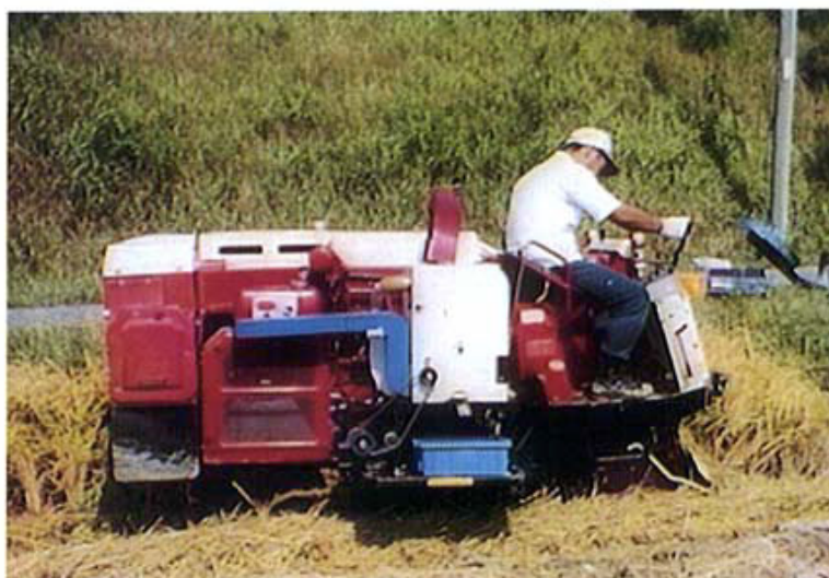
高水分籾の脱ふ機能を装備したコンバインによるイネの玄米収穫 Direct husking of high moisture content of rice
