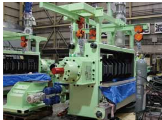
▲製造中のエキスペラー(搾油機)、これはゴマ専用の機械です
