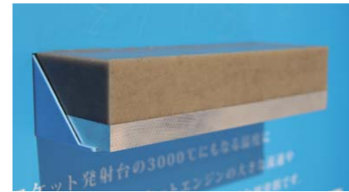
最高温度3000度から、ロケット発射台を守る分厚い耐熱塗料
