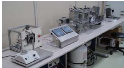
自動受精卵配列ユニットと自動マイクロインジェクションユニットを並べた試作機
