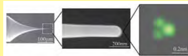
電子顕微鏡によるタングステン針の拡大図 右の図の緑の輝点は、針先端の3個のタングステン原子
