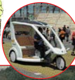
◀自転車タクシー 排気ガスを出さない、人と電気で動く無公害三輪タクシー
