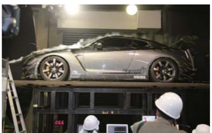
大型風洞実験施設での実験。車に風を当て、エアロパーツの性能を確かめます。
