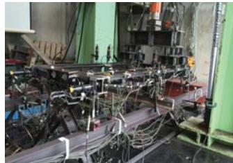
鉄骨にセンサーを設置し、強度を計測する実験
