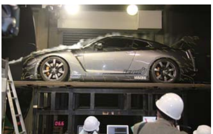
大型風洞実験施設での実験。車に風を当て、エアロパーツの性能を確かめます。
