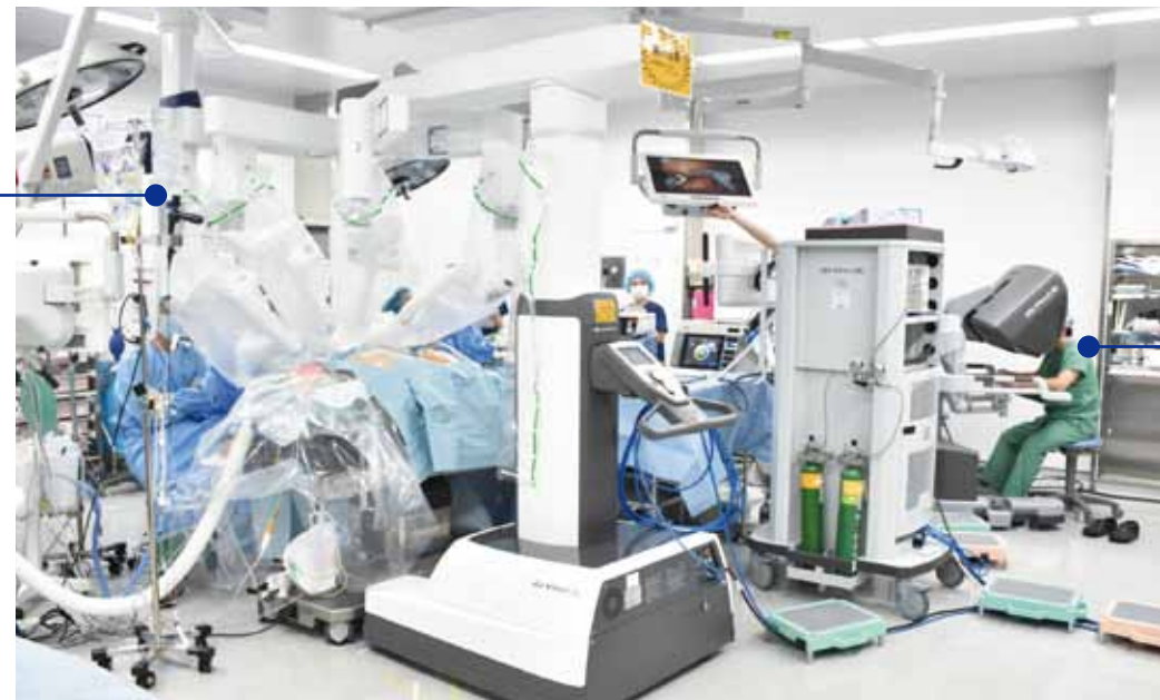
ハイブリッド手術室におけるダ・ヴィンチを使ったロボット補助下手術
