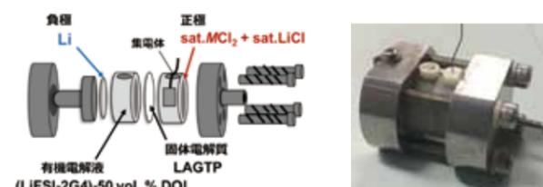
リチウム空気電池の構成材料
