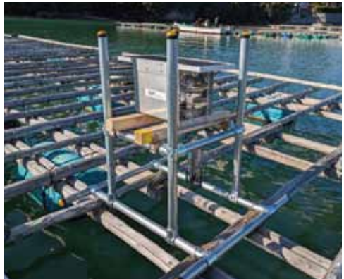
水質を自動で計測するスマートブイ
