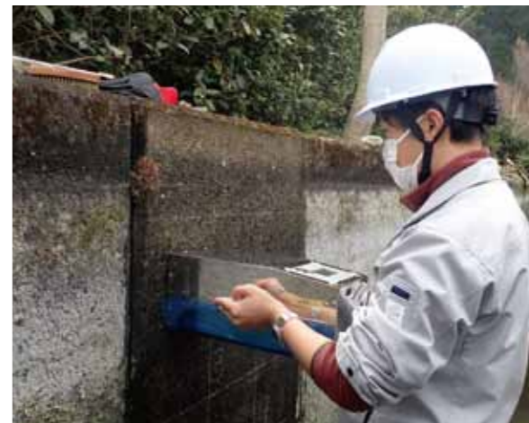
開発した超音波を使った機器で水路の粗さを計測している様子
