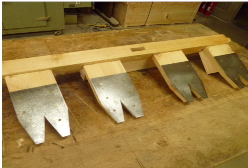
溝掘り部分は金属で作成
