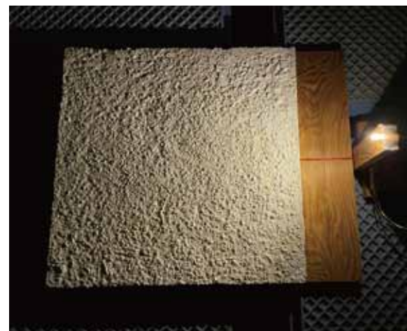
光の陰影でコンクリート面の粗さ計測している様子
