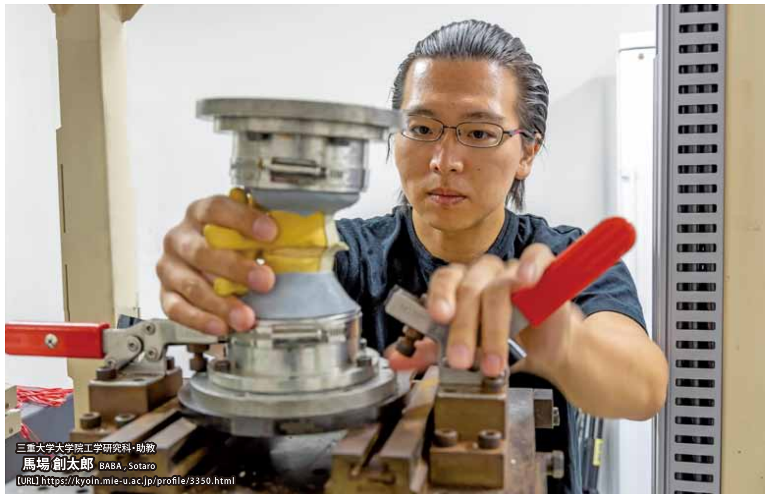
6軸材料試験機を使用した研究の様子
