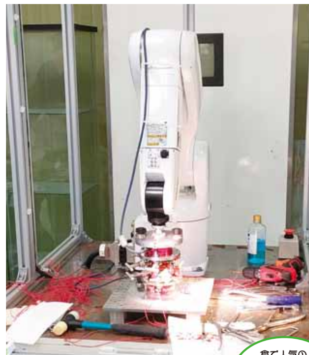
6軸材料試験機を使用した研究の様子
