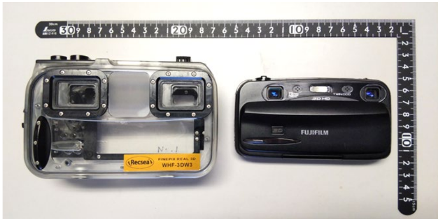
図 1. 体長推定のためのシステム. 市販の3D カメラ(右)を水中ハウジング(左)に収める.
