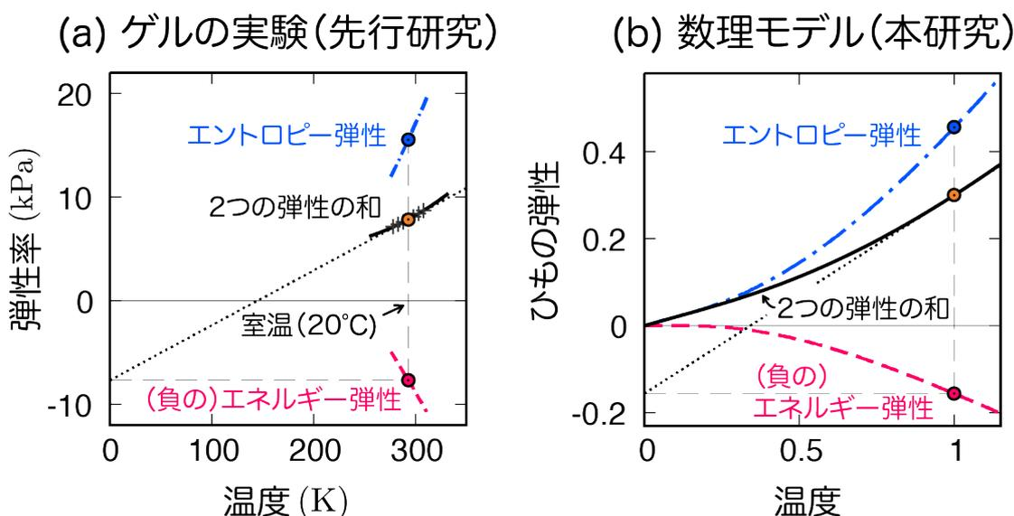
図 3: 実験と理論の比較。(a) 先行研究(参考文献 1,2)で行われたゲルの弾性率の測定結果。温度を変えて弾性率を測定することでエントロピー弾性とエネルギー弾性に分解した結果、エネルギー弾性は負の値を取ることが分かりました。(b) 数理モデルが示したひもの弾性の温度変化。ゲルを構成するひも状の分子と水分子が引き合う力(引力相互作用)によって、負のエネルギー弾性が生じることを数学的に示しました。得られた結果(b)は、ゲルの弾性率の実験結果の振る舞い(a)をよく再現しています。
