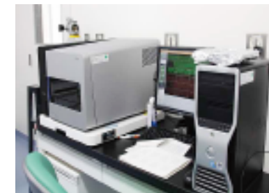
図2. DNAのメチル化解析に用いた高精度スキャナー。メチル化部位を1塩基の解像度で迅速に解析できるため、ゲノム全領域のDNAのメチル化を効率よく解析できる。
