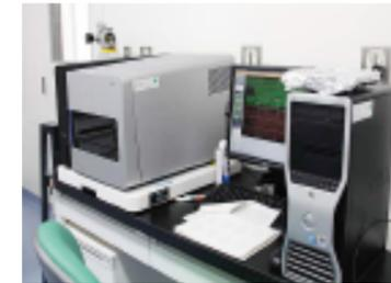
図2. DNAのメチル化解析に用いた高精度スキャナー。メチル化部位を1塩基の解像度で迅速に解析できるため、ゲノム全領域のDNAのメチル化を効率よく解析できる。
