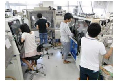
水に不安定な材料を取り扱うために、低湿度雰囲気を作り出すグローブボックス中で実験作業を行う。
