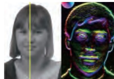
勾配ヒストグラムによる顔認識の処理過程(図4)
