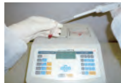
「活性酸素産生モニタリングシステム」を用いた血液内の活性酸素産生検査の様子
