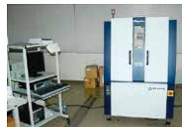
試料水平型多目的X線回折測定装置
