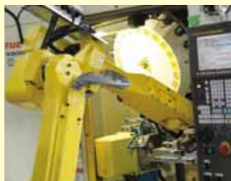
▲新たに設計・製造された治具が工作機械に取り付けられます
