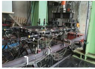
鉄骨にセンサーを設置し、強度を計測する実験
