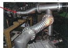
7階 絶縁ガス流出による真空ライン破損
