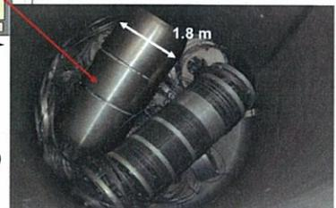
加速タンク内部 崩落 及び 絶縁ガス流失
