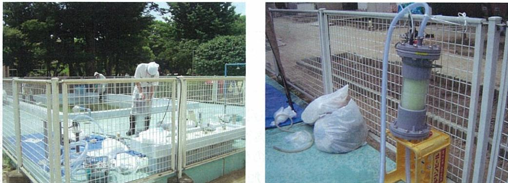
捕集材フィルタを利用した方法:(左)作業の様子、(右)捕集材フィルタ
