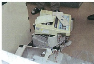
落下した高速クロマトグラフ装置
