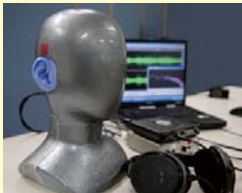
音声波形収録分析装置 (ダミーヘッド音声収録装置とコンピュータ波形収集システム)
