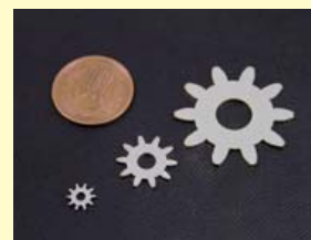
レーザ切断機で製作した小さい歯車
