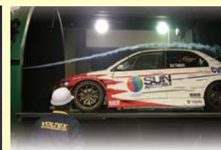
風洞による流れの可視化実験
