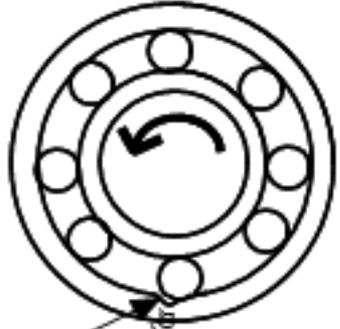
中高速回転の場合、傷による衝撃波が比較的大きいので傷信号が検出しやすい
